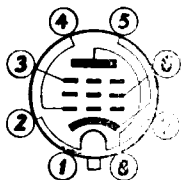
电极和管脚连接图
